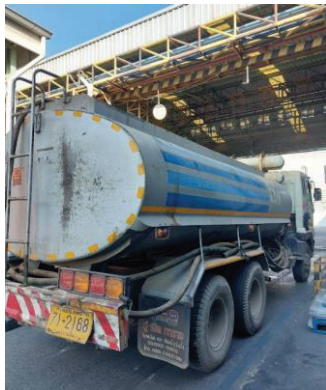
ภาพที่ 2-9 การสูบน้ำกากตะกอน
