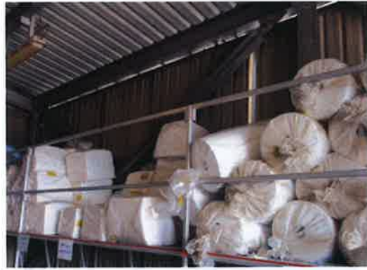
รูปที่ 3-38 อุปกรณ์รับมือน้ำมันหกรั่วไหล
