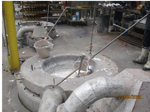
รูปที่ 50 การอุ่นเศษอลูมิเนียม และอุปกรณ์ที่ใช้ในการตักน้ำอลูมิเนียม
