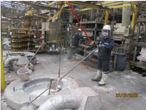
รูปที่ 50 การอุ่นเศษอลูมิเนียม และอุปกรณ์ที่ใช้ในการตักน้ำอลูมิเนียม
