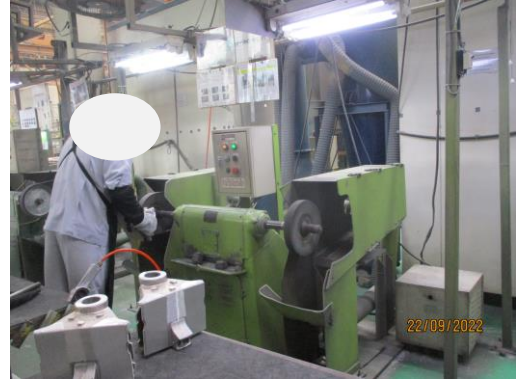
รูปที่ 38 เครื่องสกัดลมแท่นหินเจียร สำหรับตัดเจียรชิ้นงานของแผนก Finishing
