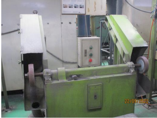
รูปที่ 38 เครื่องสกัดลมแท่นหินเจียร สำหรับตัดเจียรชิ้นงานของแผนก Finishing
