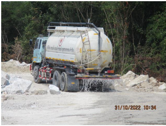
รูปที่ 3-31 การฉีดพรมน้ำบนถนนในเส้นทางขนแร่
