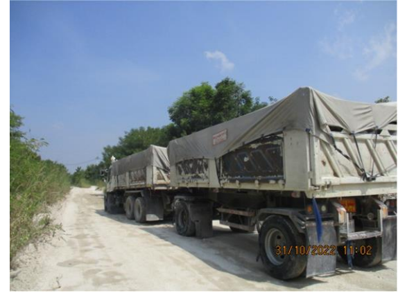
รูปที่ 3-28 การปิดคลุมกระบะรถบรรทุกแร่
