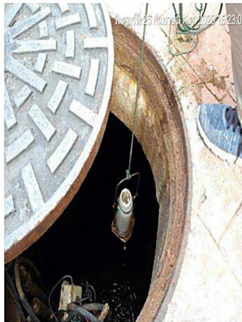
รูปภาพที่ 2 ภาพการเก็บตัวอย่างน้ำทิ้ง
