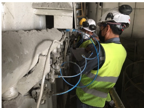
รูปที่ 57 การตรวจสอบพัดลมดูดอากาศสูงกรอง
