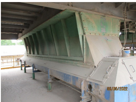
รูปที่ 12 การตรวจสอบปริมาณฝุ่นสะสม บริเวณ Hopper หรือ Conveyors
