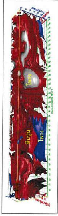
รูปที่ 27 รูปแบบจำลองค่าสภาพด้านทานไฟฟ้า 3 มิติ L1-L3 พื้นที่ 1240
