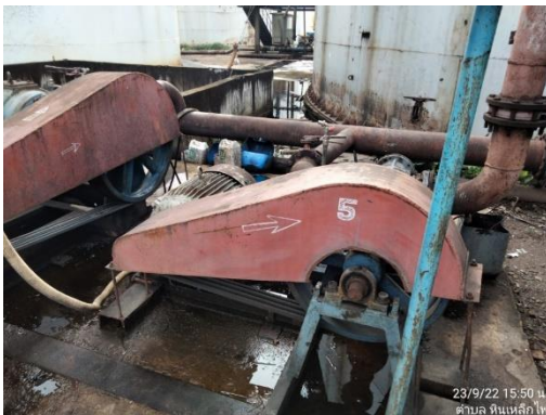
รูปที่ 95 การ์ดป้องกันอันตรายและปุ่มหยุดฉุกเฉิน
