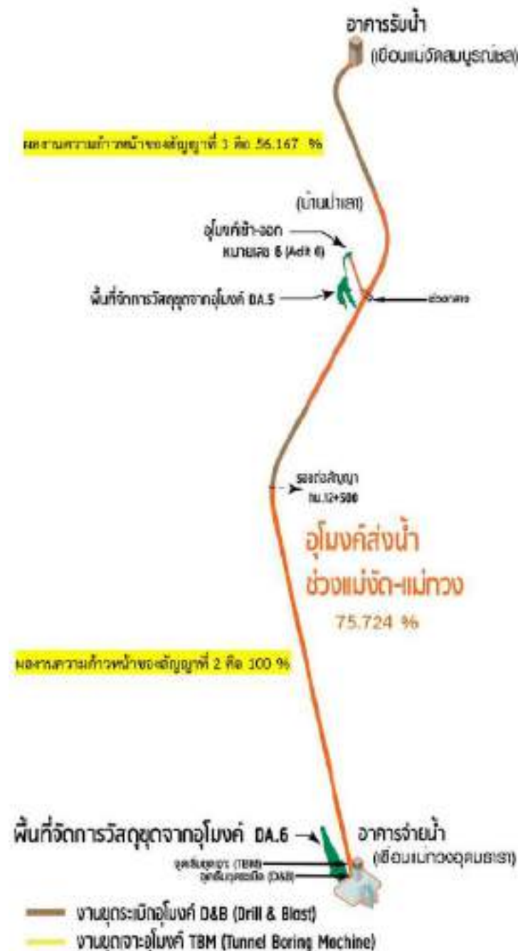
รูปที่ 1-2 ความก้าวหน้างานก่อสร้างอุโมงค์ส่งน้ำช่วงแม่จัด – แม่ทอง
