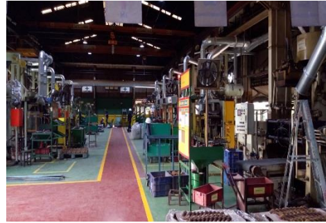
ภาพที่ 35 ระบบรวบรวมอากาศด้านบน เครื่อง shell core
