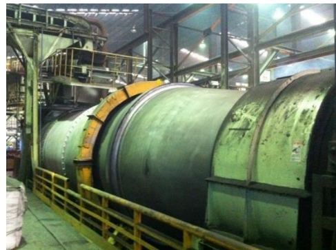
ภาพที่ 6 เครื่องเขย่าชิ้นงานแบบอูโมงค์
