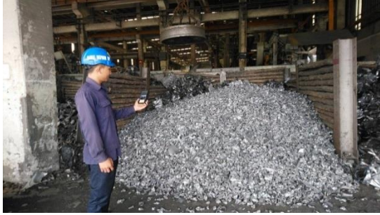
ภาพที่ 32 การสุ่มตรวจวัดสารกำมะถันตรงสีในเหล็กก้อน
