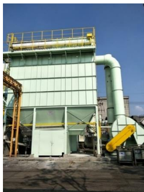
ภาพที่ 3 Bag house (Melting furnace 1, 2)
