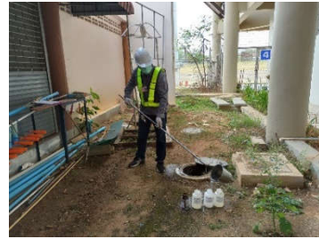
บ่อบำบัดน้ำทิ้งผ่านระบบบำบัดน้ำเสียสำเร็จรูปของอาคารผู้โดยสารขาออก
