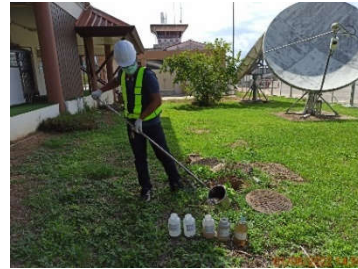
บ่อฟักน้ำหลังผ่านระบบบำบัดน้ำเสียสำเร็จรูปของอาคารหอบังคับการบิน
