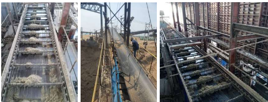
รูปที่ 2-18 ระบบสายพานลำเลียงกากอ้อยเข้าห้องเผาไหม้
