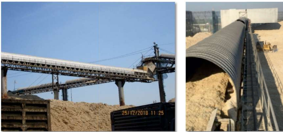
รูปที่ 2-10 ระบบสายพานโซ่ลำเลียงแบบปิดครอบ (Chain Conveyor)
