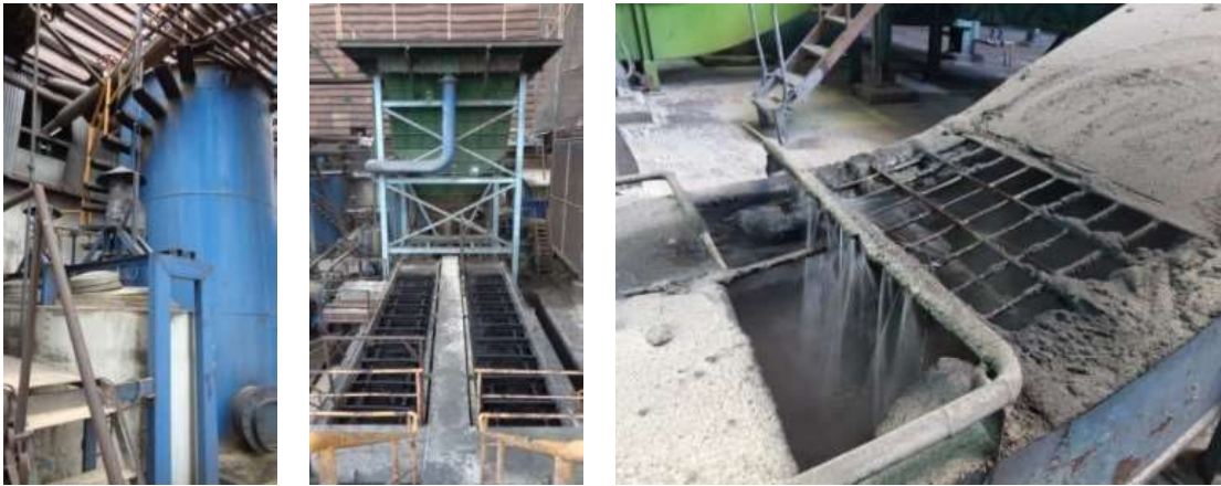
รูปที่ 2-19 ถังตกตะกอน (Clarifier) และ Ash Chain Conveyor
