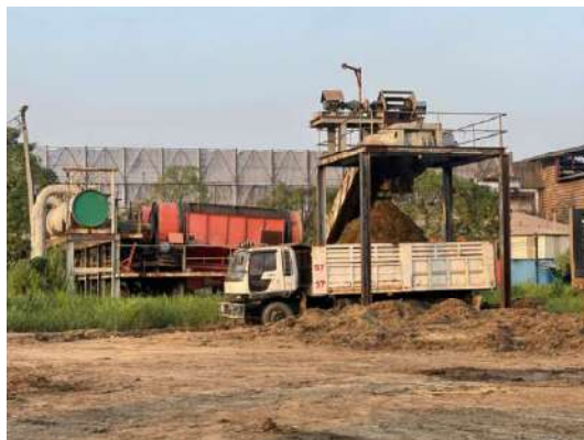
รูปที่ 3-22 โรตารีคัดแยกกากอ้อยก่อนเข้าสู่ระบบบำบัดน้ำเสีย
