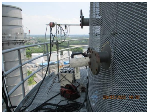
ภาพที่ 2-2 การตรวจวัดคุณภาพอากาศจากปล่องระบายอากาศ
