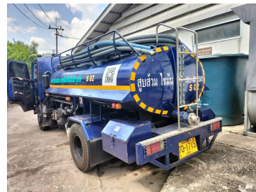
ภาพที่ 3-C สูบตะกอนส่วนเกินไปกำจัด ทุกวันที่ 10,20,30 ของเดือน
