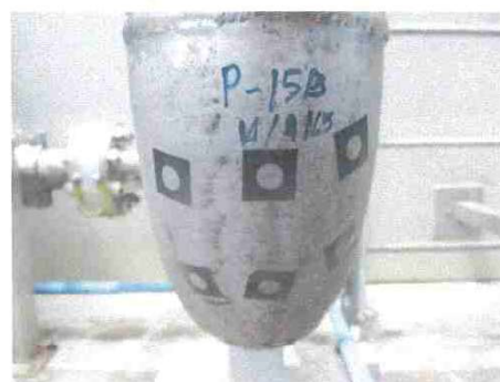
จุดที่ 28 การทดสอบวัดความหนา
