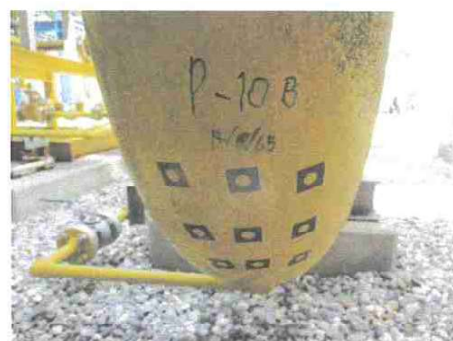
จุดที่ 24 การทดสอบวัดความหนา
