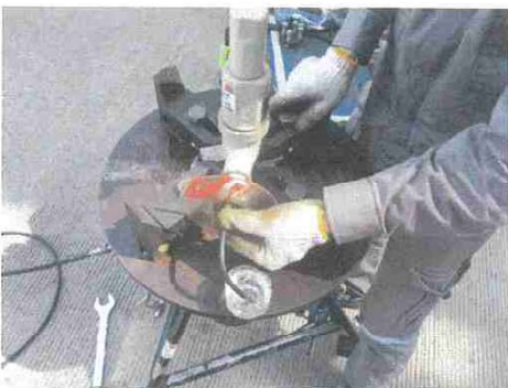
รูปที่ 5 การทดสอบการรั่วซึม / SEAT LEAKAGE TEST
