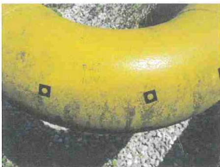
จุดที่ 11 การทดสอบวัดความหนา
