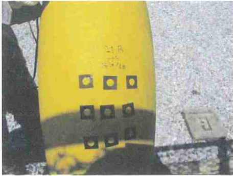
จุดที่ 1 การทดสอบวัดความหนา
