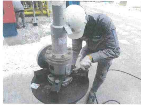
รูปที่ 2 การทดสอบกล่อปกรณํ้ารั่ว
