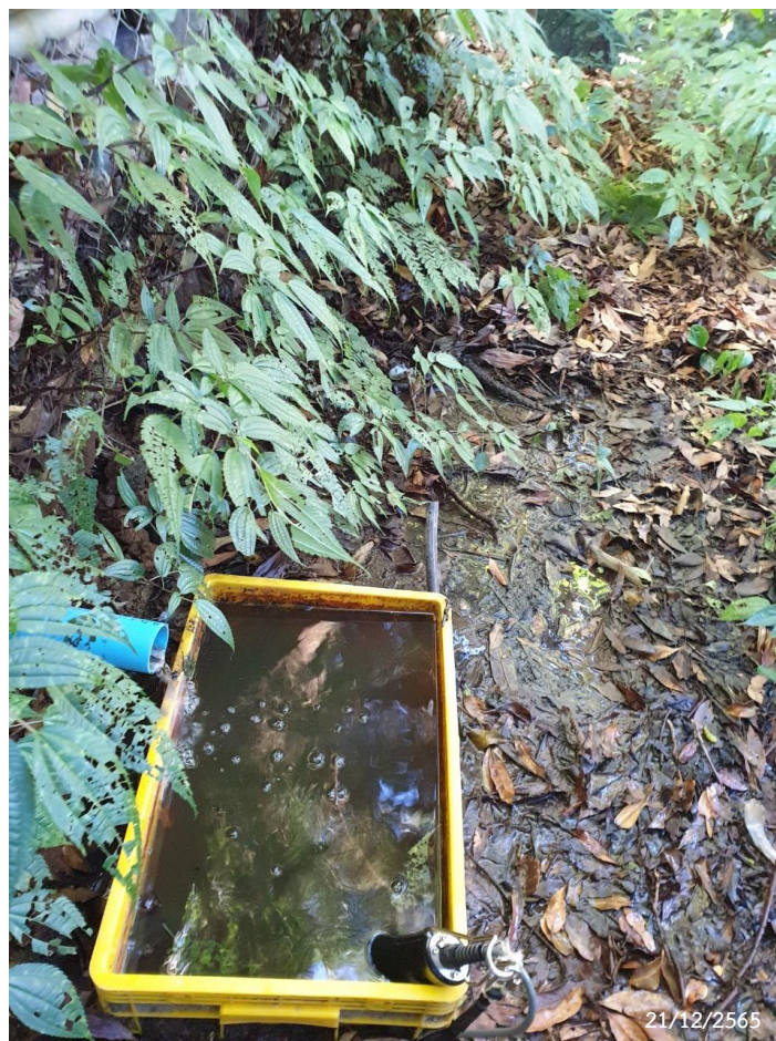
ภาพที่ 13 จุดที่มีการวางระบบบำบัด และจุดที่ได้ทำการเก็บตัวอย่างน้ำเสียที่ระบายออกจากระบบบำบัด
