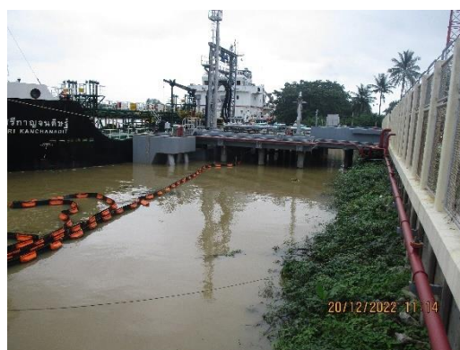
ภาพที่ 2-8 การควบคุมการรั่วไหลของน้ำมันระหว่างการขนถ่าย
