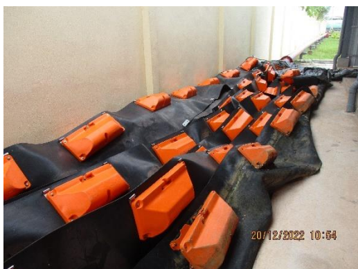
ภาพที่ 2-7 การจัดเตรียมอุปกรณ์กำจัดการปนน้ำมัน
