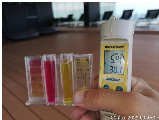
ภาพที่ 3.5.3-2 การตรวจวัด pH และ Cl2 สระว่ายน้ำ
