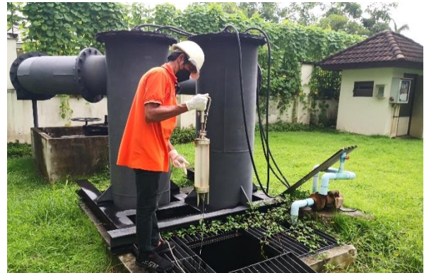
รูปที่ 2-19 การเก็บตัวอย่างน้ำจากระบบบำบัดน้ำเสีย
