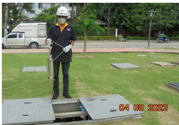
รูปที่ 2-25 การเก็บตัวอย่างน้ำจากระบบบำบัดน้ำเสีย
