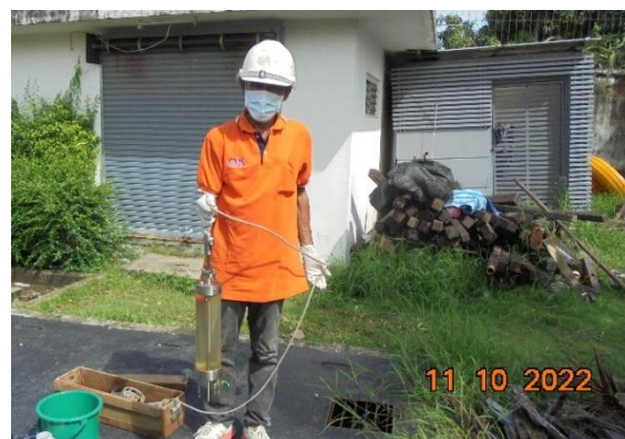
รูปที่ 2-25 การเก็บตัวอย่างน้ำจากระบบบำบัดน้ำเสีย
