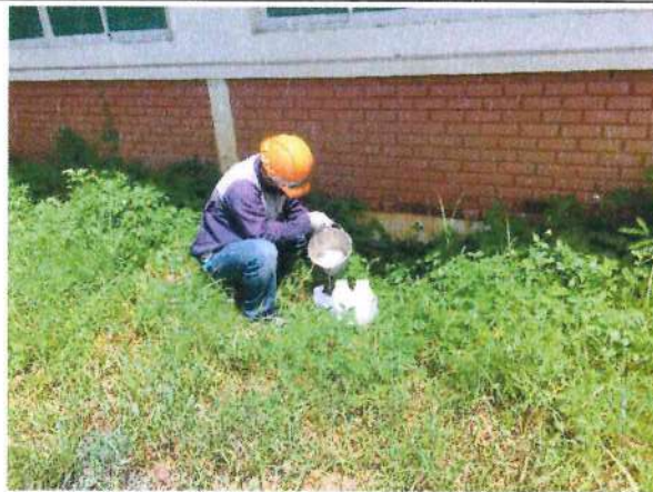
รูปที่ 4.3-60 การเก็บตัวอย่างน้ำทิ้ง น้ำทิ้งจากระบบบำบัดน้ำเสียในพื้นที่ก่อสร้าง
