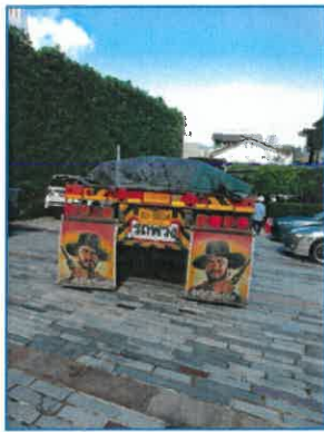
ภาพถ่ายที่ 2.1-8 ผ้าใบปิดคลุมกระบะรถที่ขนส่งวัสดุก่อสร้าง
