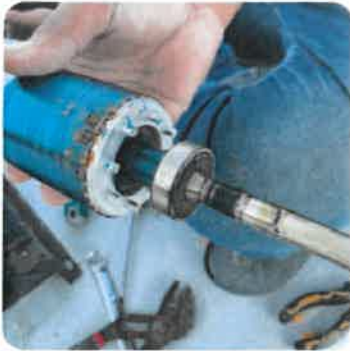
ภาพถ่ายที่ 2.2-7 การเปลี่ยนอุปกรณ์ปั๊มน้ำขาดฟ้าที่ชำรุด
