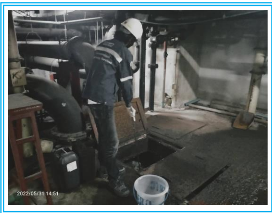
บ่อ Aerated Grit Chamber (ก่อนผ่านระบบฯ) เก็บตัวอย่างในวันที่ 30 พฤษภาคม 2565
