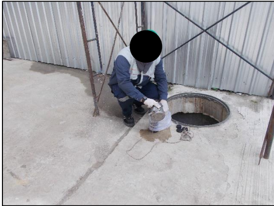
บ่อตรวจคุณภาพน้ำก่อนปล่อยออกสู่คลองสาธารณะประโยชน์ด้านหลังโครงการ
