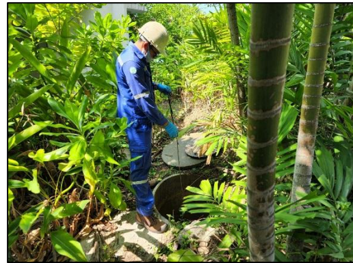
รูปที่ 3.1-3 จุดตรวจวัดคุณภาพน้ำทิ้ง บริเวณน้ำทิ้งก่อนบำบัด (Influent Tank) ระบบบำบัดน้ำเสีย อาคารสันทนาการ ประจำเดือนมกราคม - มิถุนายน พ.ศ. 2565
