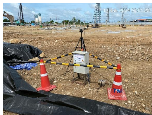
รูปที่ 31 ตั้งเครื่องตรวจวัดคุณภาพสิ่งแวดล้อมบริเวณพื้นที่โครงการ
