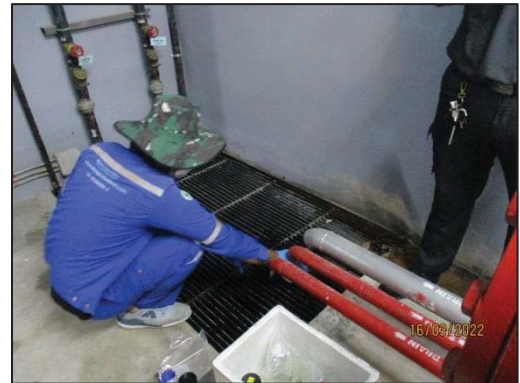
รูปที่ 12 เก็บตัวอย่างน้ำในถังเก็บน้ำใต้ดินมาวิเคราะห์หาเชื้อ E. coli
