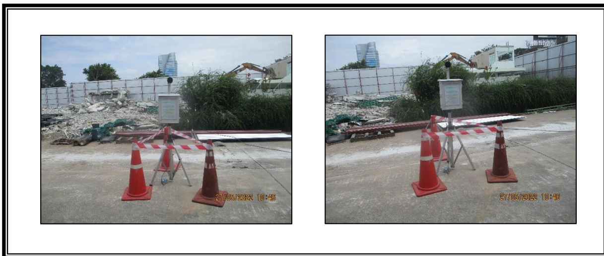
รูปที่ 3.2-1 ตรวจวัดระดับเสียงทั่วไป บริเวณภายในพื้นที่รื้อถอน
