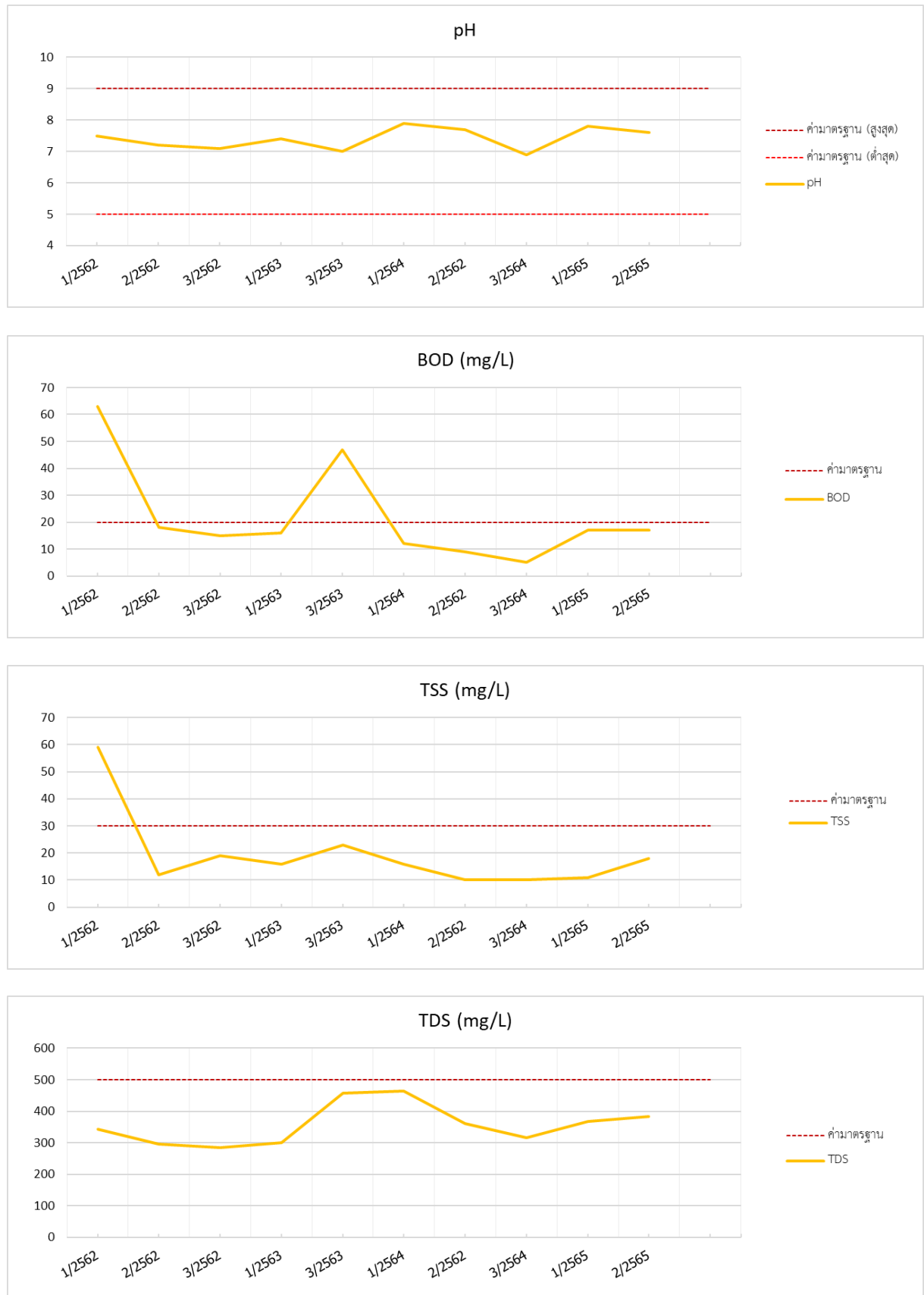
รูปที่ 3-1 กราฟแสดงผลการตรวจวิเคราะห์คุณภาพน้ำทิ้ง
