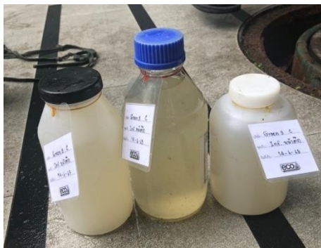
น้ำเสียก่อนเข้าระบบบำบัด (Influent) หน้าอาคาร ซี
