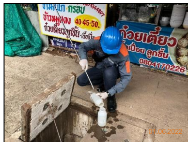
บ่อฟักน้ำทิ้งสุดท้ายก่อนระบายออกจากพื้นที่โครงการ
