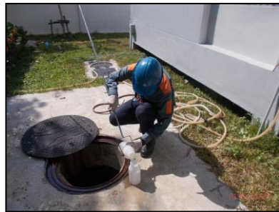
จุดเก็บน้ำก่อนเข้าระบบบำบัดน้ำเสียอาคาร 4
