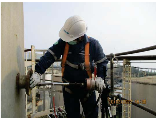
รูปที่ 4-49 แสดงการตรวจวัดคุณภาพอากาศจากปล่อง ปล่อง Boiler No.1 (Soot Blow) เดือนกุมภาพันธ์ 2565
