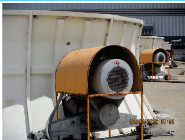
รูปที่ 3-40 อุปกรณ์ปิดครอบเครื่องจักรที่มีเสียงดัง
