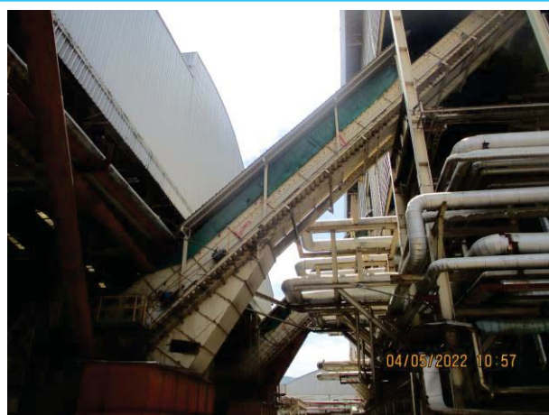
รูปที่ 3-6 ระบบสายพานลำเลียงเชื้อเพลิงจากกระบวนการสกัด น้ำอ้อยแผนกกลูทิบของโรงงานน้ำตาลนิวกูญไทย
