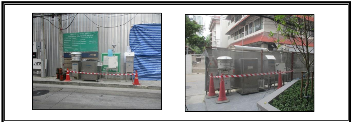
รูปที่ 3.1-1 จุดตรวจวัดคุณภาพอากาศในบรรยากาศทั่วไป บริเวณพื้นที่ก่อสร้างอาคารของโครงการ
