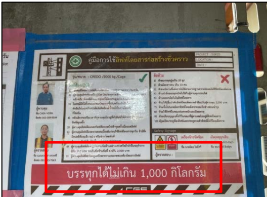
ภาพที่ 62 ป้ายบอกน้ำหนักบรรทุกสูงสุดของลิฟต์
