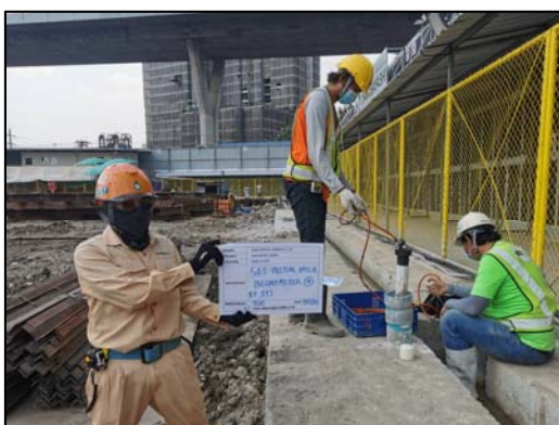
ภาพที่ 35 การตรวจวัดการเคลื่อนตัวของดิน (Inclinometer)
