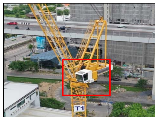
ภาพที่ 64 กระจกปิดมิดชิดที่ Cabin ของ Tower Crane
