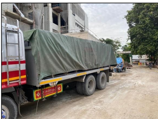
ภาพที่ 12 ผ้าใบปิดคลุมกระบะรถขนส่งวัสดุก่อสร้าง
