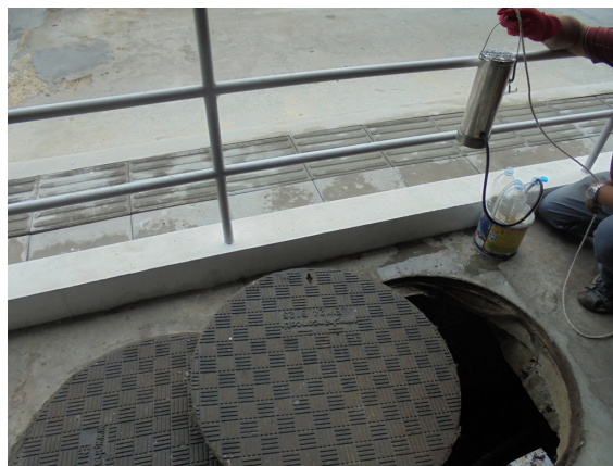
จุดเก็บน้ำทิ้งที่บ่อพักน้ำทิ้งหลังผ่านการบำบัดน้ำเสีย
