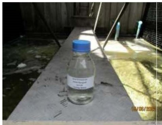
Cooling Water Sample น้ำจากอ่างรองรับน้ำที่ระบบ Cooling Tower
