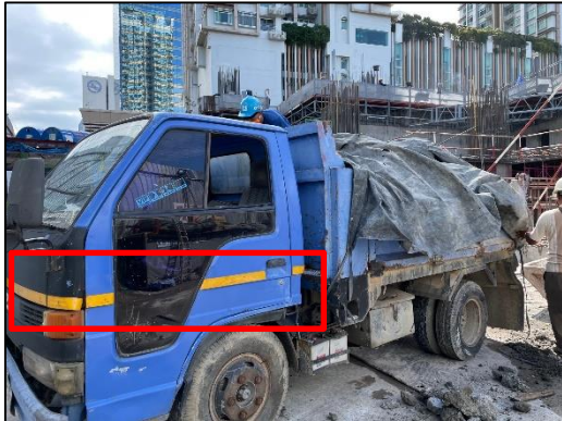
ภาพที่ 28 ติดแผ่นสะท้อนแสงข้างรถ
