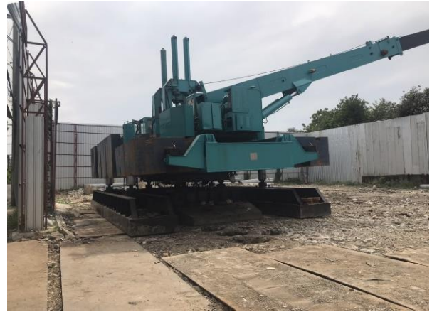
รูปที่ 2.6 เครื่องจักรกวดเสาเข็ม
