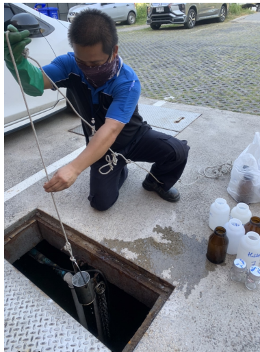
เก็บตัวอย่างน้ำทิ้งที่บ่อพักน้ำหลังออกจากระบบบำบัดน้ำเสีย
