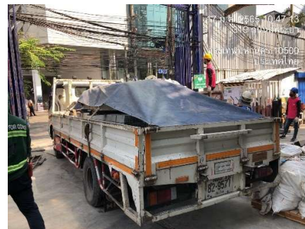
รูปที่ 36 รถบรรทุกติดแผ่นป้ายสะท้อนแสง/รถบรรทุกคลุมท้ายด้วยผ้าใบ
