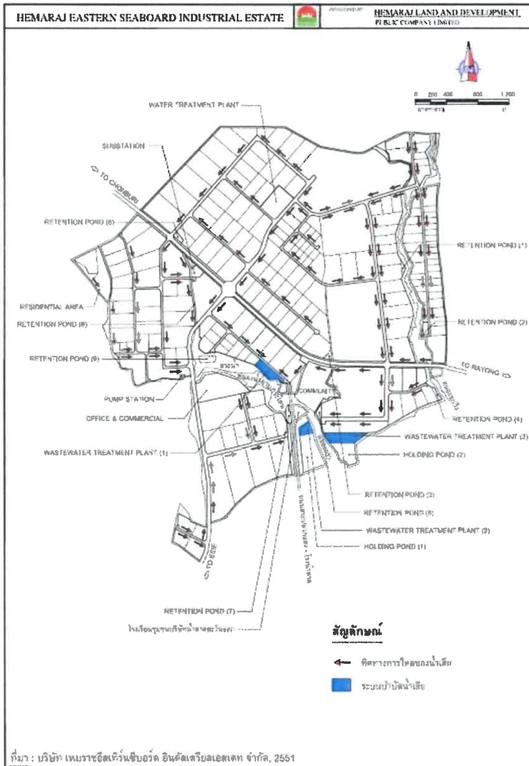
รูปที่ 1-10 ผังระบบรวบรวมน้ำเสีย
