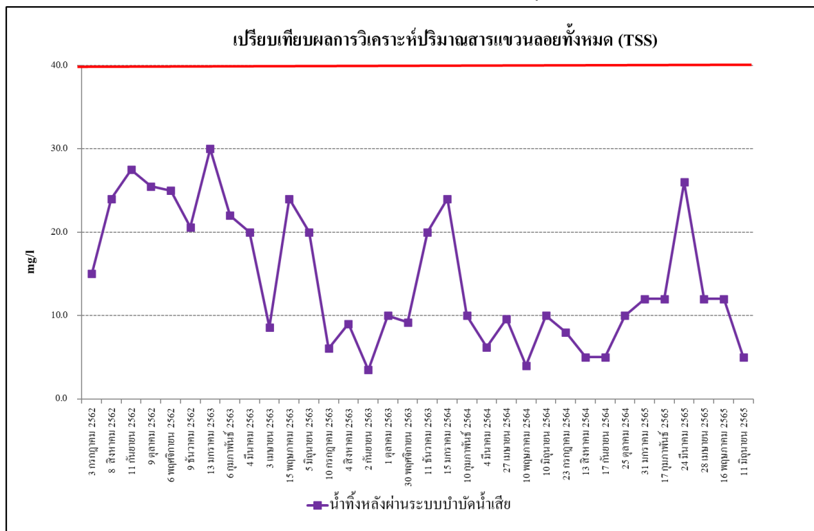
รูปที่ 4.4-25 เปรียบเทียบผลการวิเคราะห์ปริมาณสารแขวนลอยทั้งหมด (Total Suspended Solids) บริเวณบ่อน้ำเสียหลังผ่านระบบบำบัด ระหว่างเดือนกรกฎาคม 2562-มิถุนายน 2565
