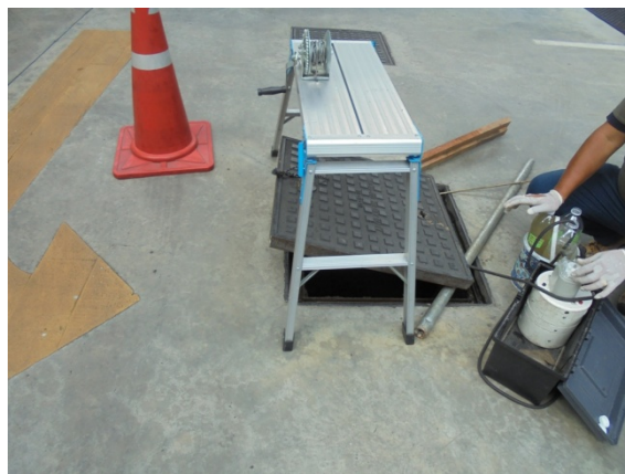
เก็บตัวอย่างน้ำทิ้งที่บ่อพักน้ำใสหลังจากจากระบบบำบัดน้ำเสีย ด้วยวิธี Sampling Pump
