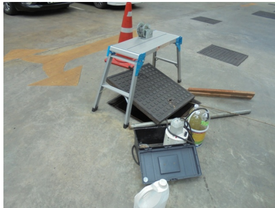
เก็บตัวอย่างน้ำทิ้งที่บ่อปรับสมดุลน้ำเสีย ด้วยวิธี Sampling Pump
