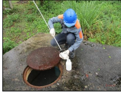
จุดเก็บน้ำหลังผ่านระบบบำบัดน้ำเสียส่วนกลาง
