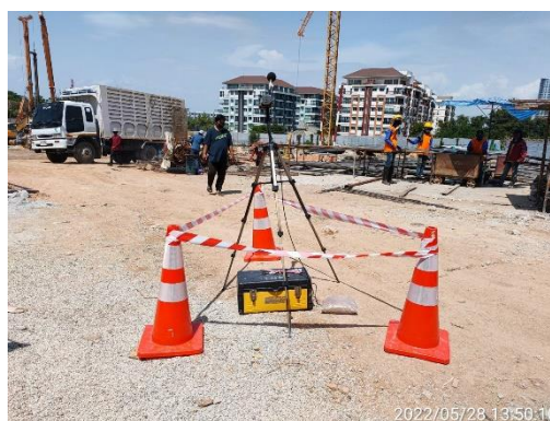
รูปที่ 21 ตั้งเครื่องตรวจวัดคุณภาพสิ่งแวดล้อม คุณภาพอากาศ ระดับเสียง เสียงรบกวน ความสั่นสะเทือน
