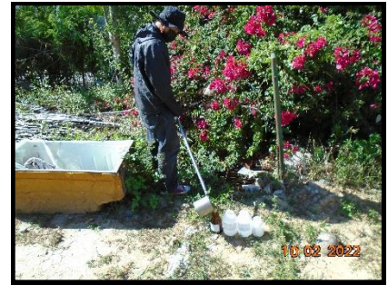
บ่อดตรวจวัดคุณภาพน้ำก่อนระบายออก จากโครงการ ชุดที่ 2
